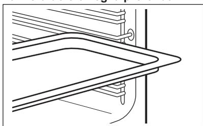
Spingere la lamiera tra le guide del supporto ripiano. Posizionare la lamiera dolci con la pendenza verso la parte posteriore dell'interno del forno.
