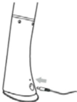
Inserire il cavo di alimentazione nella presa sulla lampada, quindi inserire l'altra estremità del cavo nell'alimentatore USB e collegare l'alimentatore nella presa di corrente elettrica.
