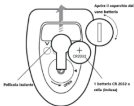
Il prodotto utilizza una batteria CR2032 per mantenere le impostazioni quando non è collegato ad una presa di alimentazione. Per utilizzare il prodotto la prima volta è necessario togliere la linguetta di plastica che isola la batteria.
