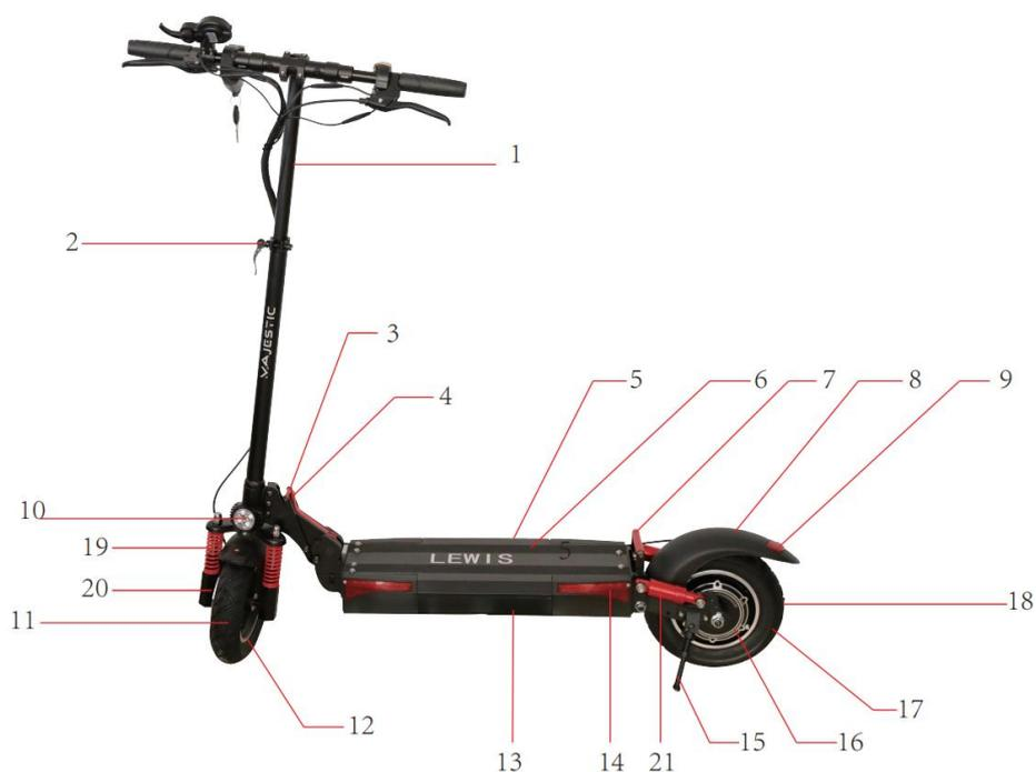
1. Tubo anteriore 2. Leva blocco manubrio 3. Gancio blocco telaio 4. Leva blocco telaio 5. Porta di ricarica 6. Base antiscivolo 7. Maniglia per il trasporto 8. Parafanghi posteriore 9. Faro posteriore 10. Faro anteriore 11. Pneumatico anteriore 12. Freno a disco anteriore 13. Base con batteria al suo interno 14. Indicatori di direzione 15. Cavalletto 16. Motore 17. Pneumatico posteriore Freno a disco posteriore 19. Sospensioni anteriori 20. Freno a disco anteriore 21. Sospensioni posteriori.
