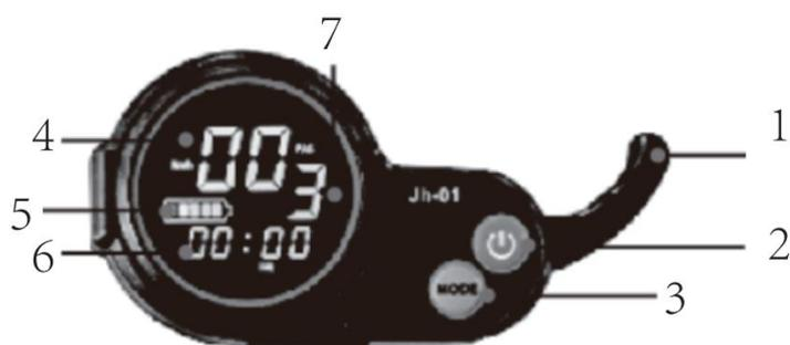
1. Acceleratore 2. Tasto accensione/spegnimento 3. Tasto Funzione 4. Velocità 5. Stato batteria 6. Tempo accensione 7. Visualizzazione marcia.
