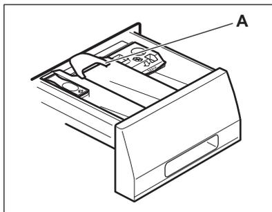
4. Per utilizzare il detersivo liquido, ruotare l'inserito verso il basso.
