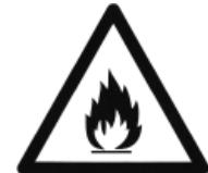
ympäristövaikutuksia, mutta se on tulenarkkaa. Varmista siksi, ettei mikään jäähdytyspiiri osista vahingoitu kuljetuksen ja laitteen asennuksen aikana. Jos jäähdytyspiiri vahingoittuu, älä käynnistä laitetta äläkä kytke sitä verkkovirtaan, vaan siirrä avoin tuli ja kaikki muut herkästi syttymisen lähteet pois kylmäkaasun läheisyydestä ja tuuleta sitten huone, jossa laite sijaitsee.
