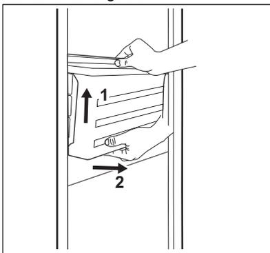
4. Spingere i binari nel mobiletto per evitare di danneggiare l'apparecchiatura in fase di chiusura della porta.
