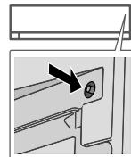
Utilizado cuando el mando a distancia está extraviado o funciona mal. Abra el panel frontal:
