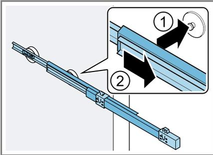
2. Inserire la guida telescopica sul perno posteriore ① e spingere all'indietro il bloccaggio ②.
