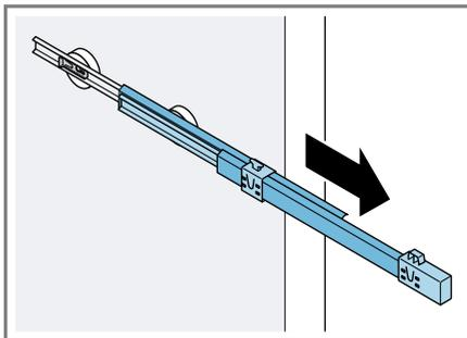
2. Spingere il bloccaggio nella direzione della freccia ① e allentarlo dal perno posteriore ②.
