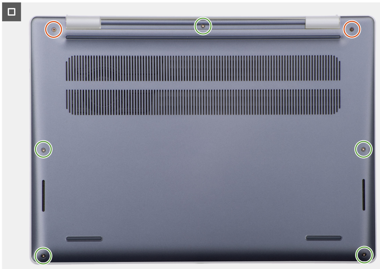
Figura 19. Installazione del coperchio della base
