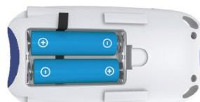
Versichern Sie sich, dass die Batterien richtig eingesetzt wurden und das schwarze Band unterhalb der Batterien liegt.
