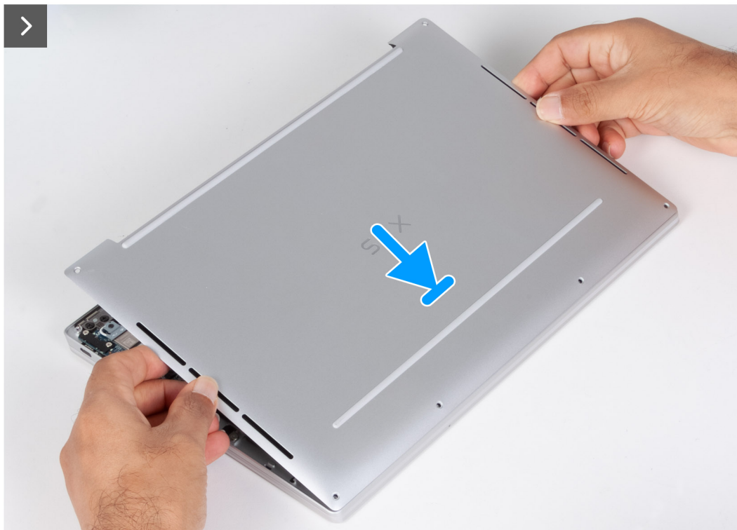
Figura 12. Installazione del coperchio della base
