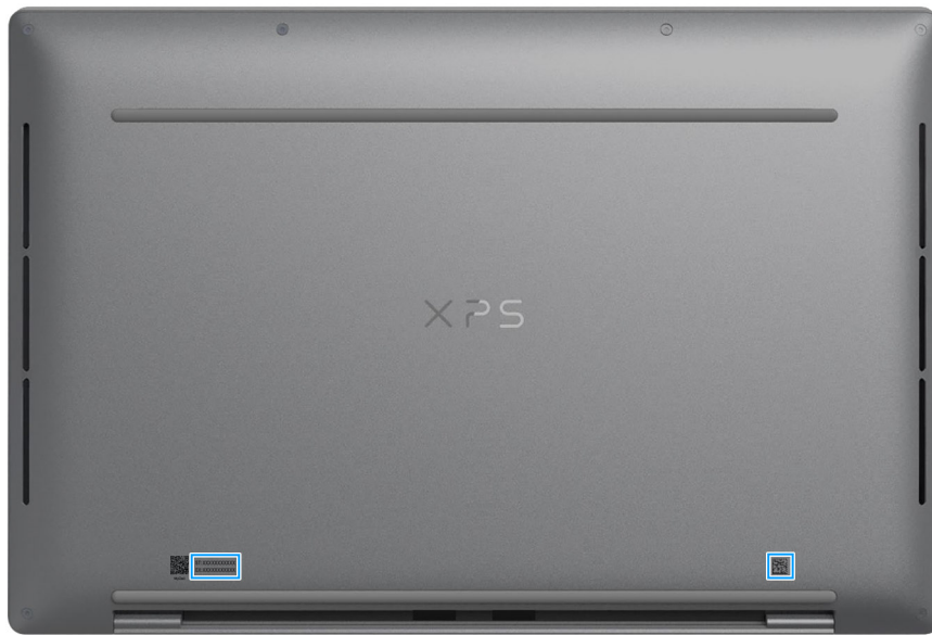
Figura 6. Posizione del codice di matricola/codice di servizio rapido
