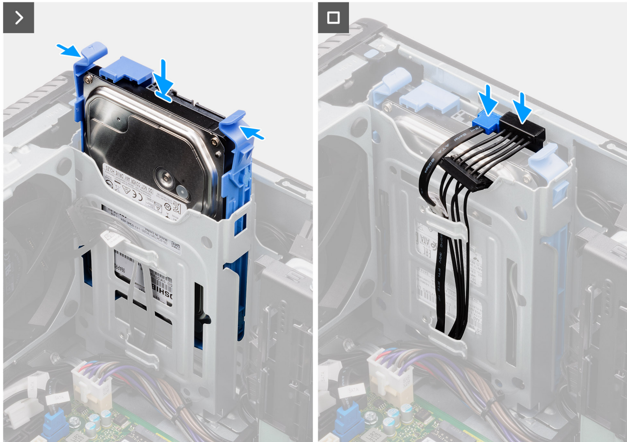
Figura 20. Installazione del gruppo del disco rigido da 3,5 pollici (Bay-2)
