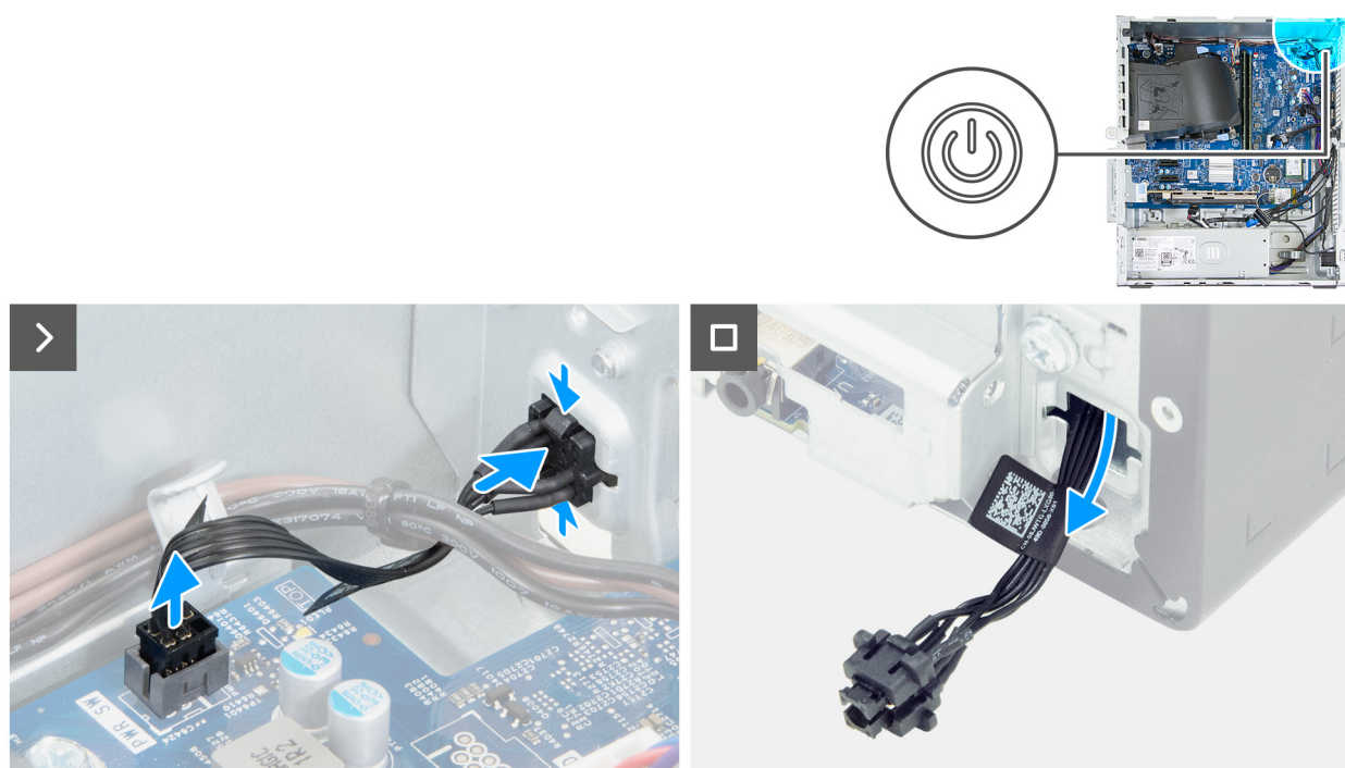
Figura 50. Rimozione del pulsante di accensione
