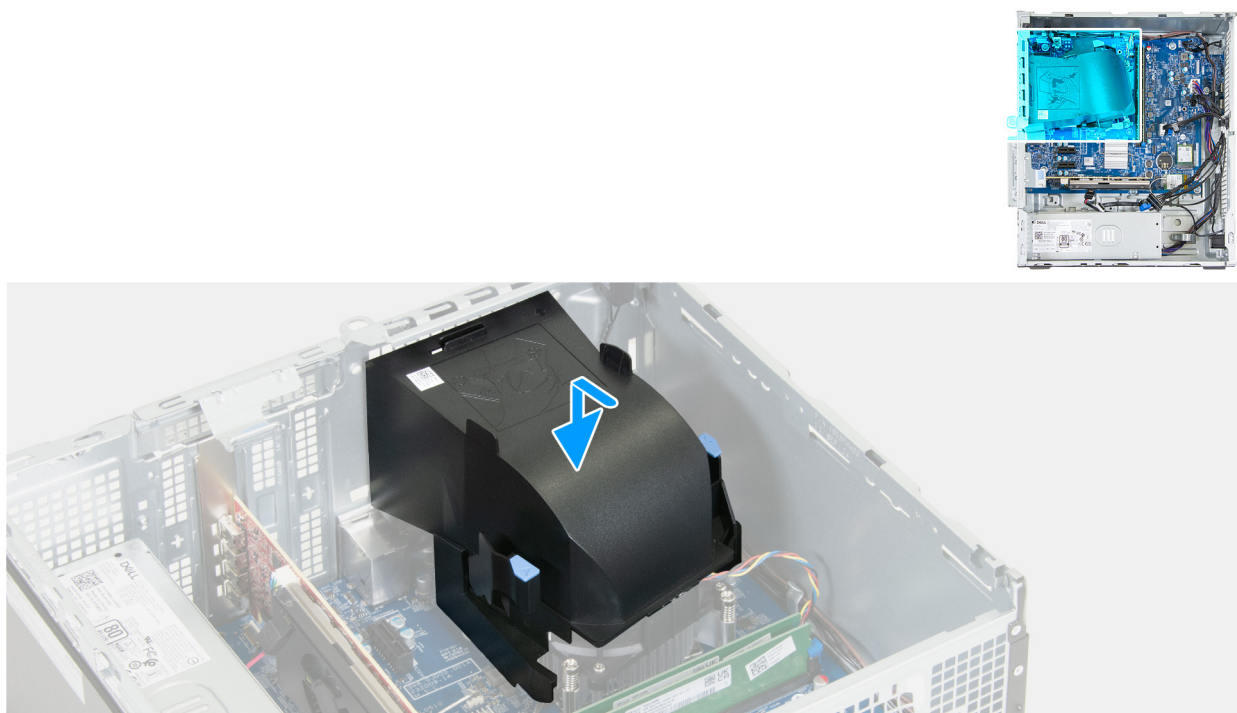
Figura 53. Immagine: Installazione del manicotto della ventola
