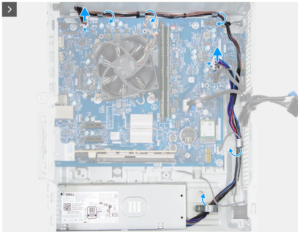
Figura 62. Rimozione dell'unità di alimentazione
