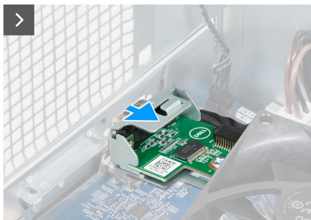
Figura 57. Rimozione del modulo della porta seriale
