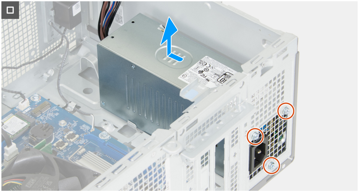
Figura 63. Rimozione dell'unità di alimentazione
