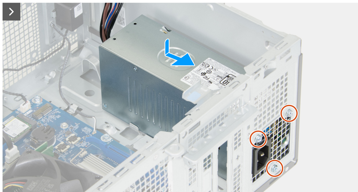
Figura 64. Installazione dell'unità di alimentazione
