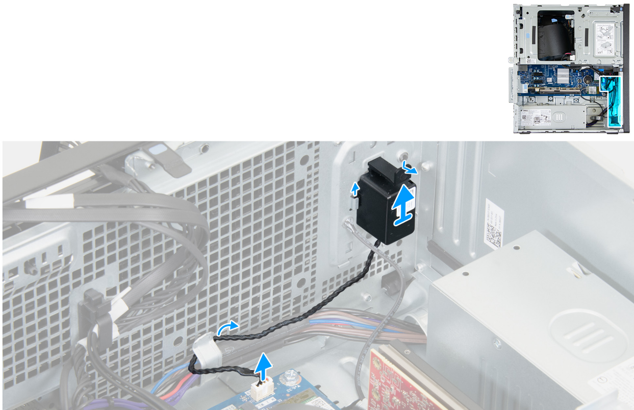
Figura 25. Rimozione dell'altoparlante interno
