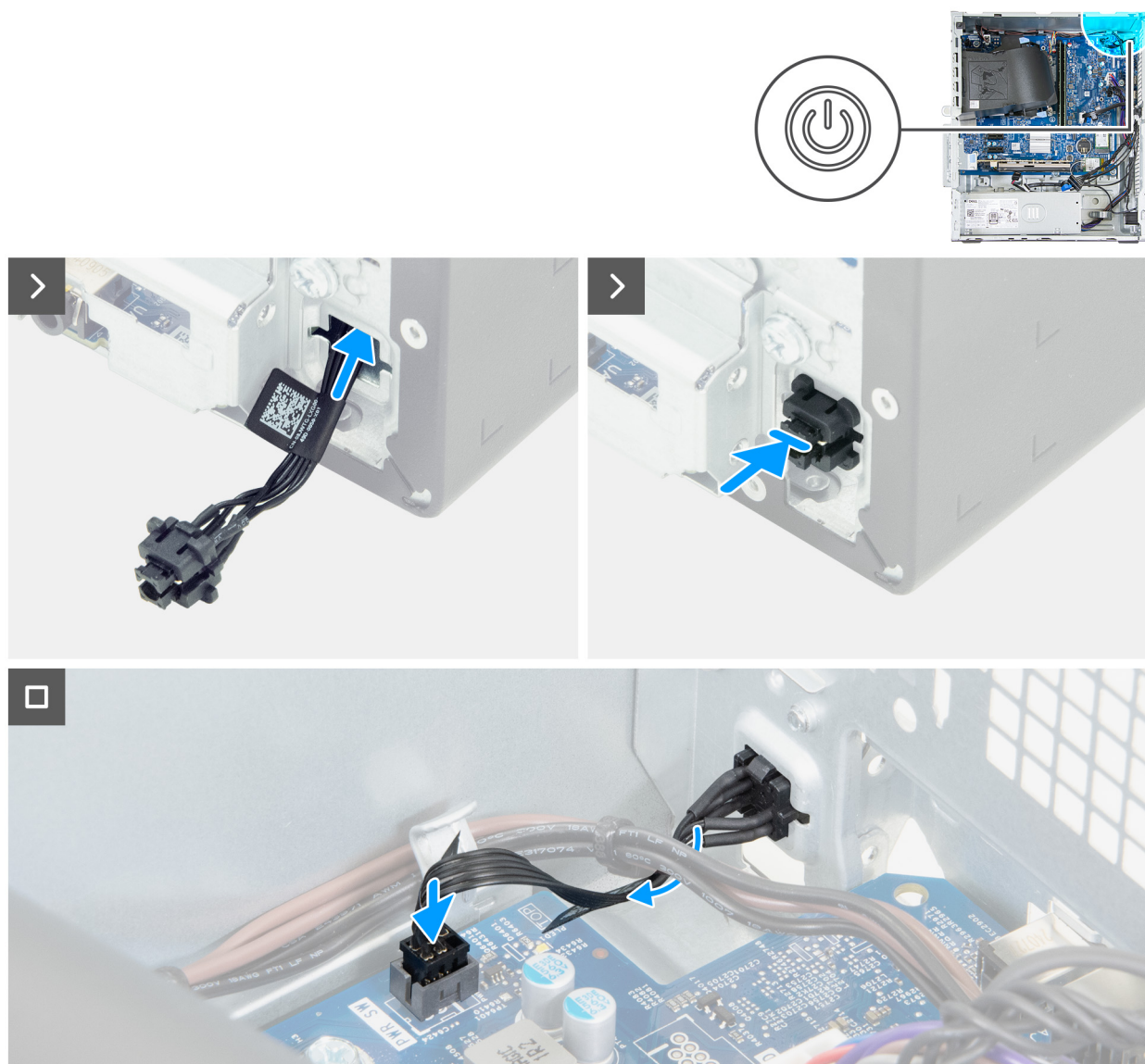
Figura 51. Installazione del pulsante di accensione
