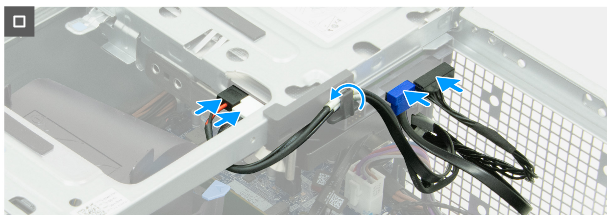
Figura 45. Installazione del drive bay
