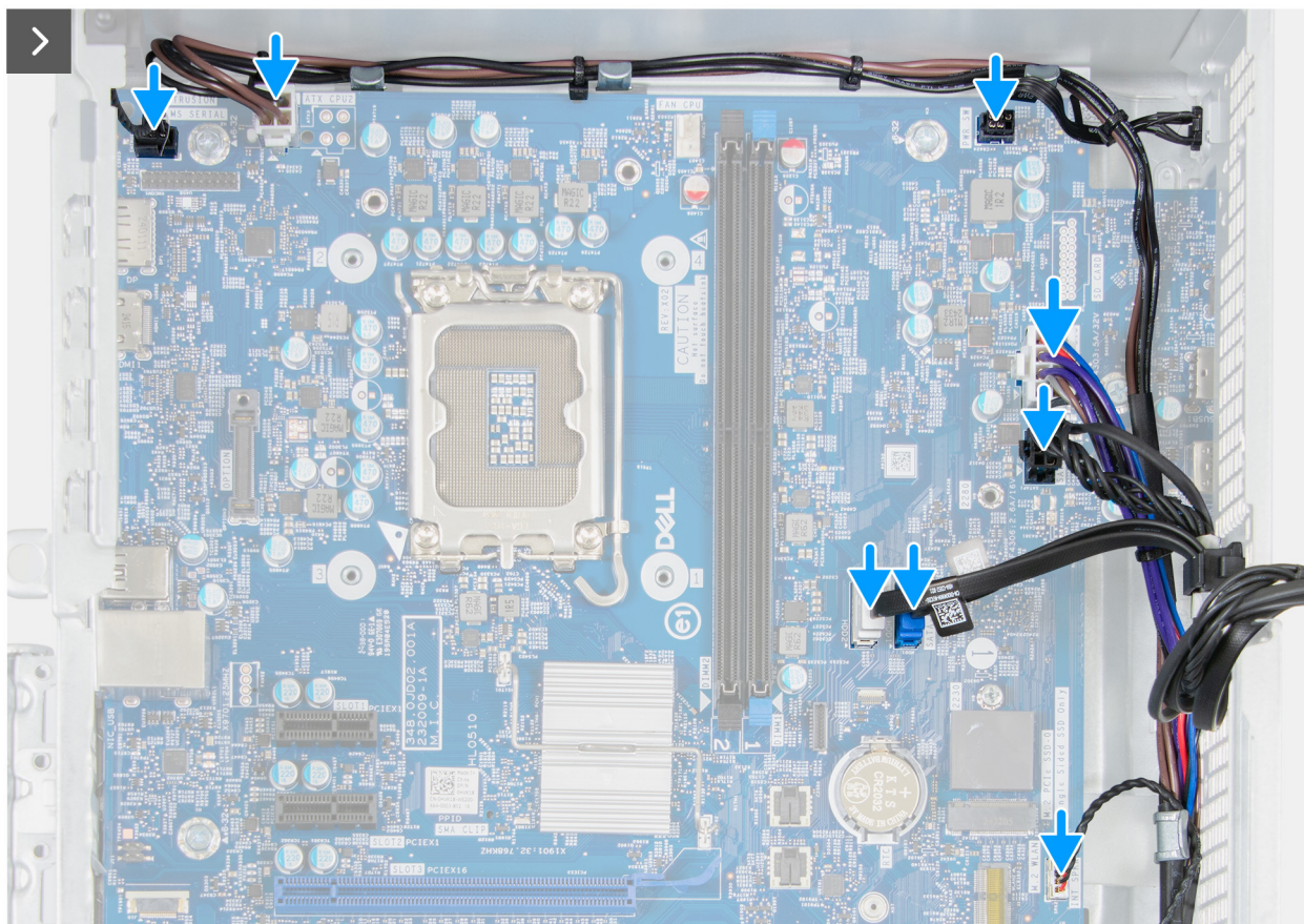
Figura 78. Installazione della scheda di sistema
