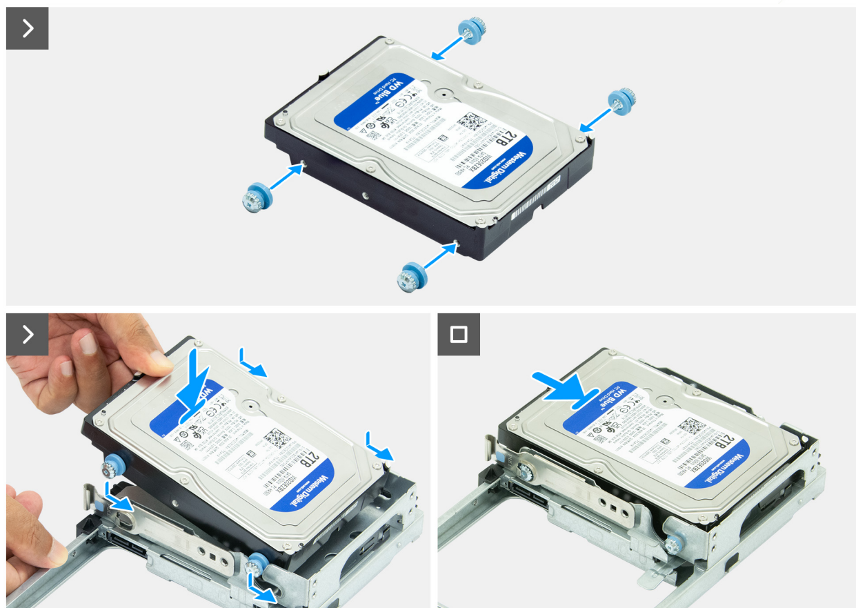
Figura 47. Installazione del disco rigido
