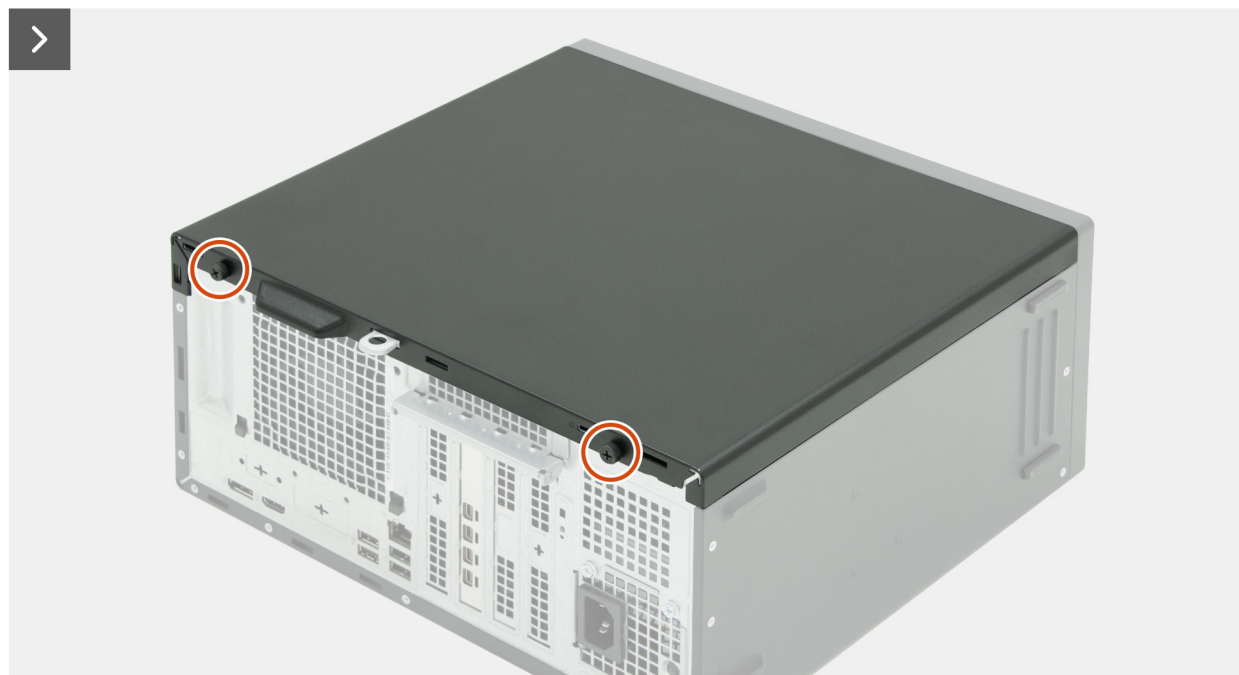
Figura 13. Rimozione del pannello laterale sinistro
