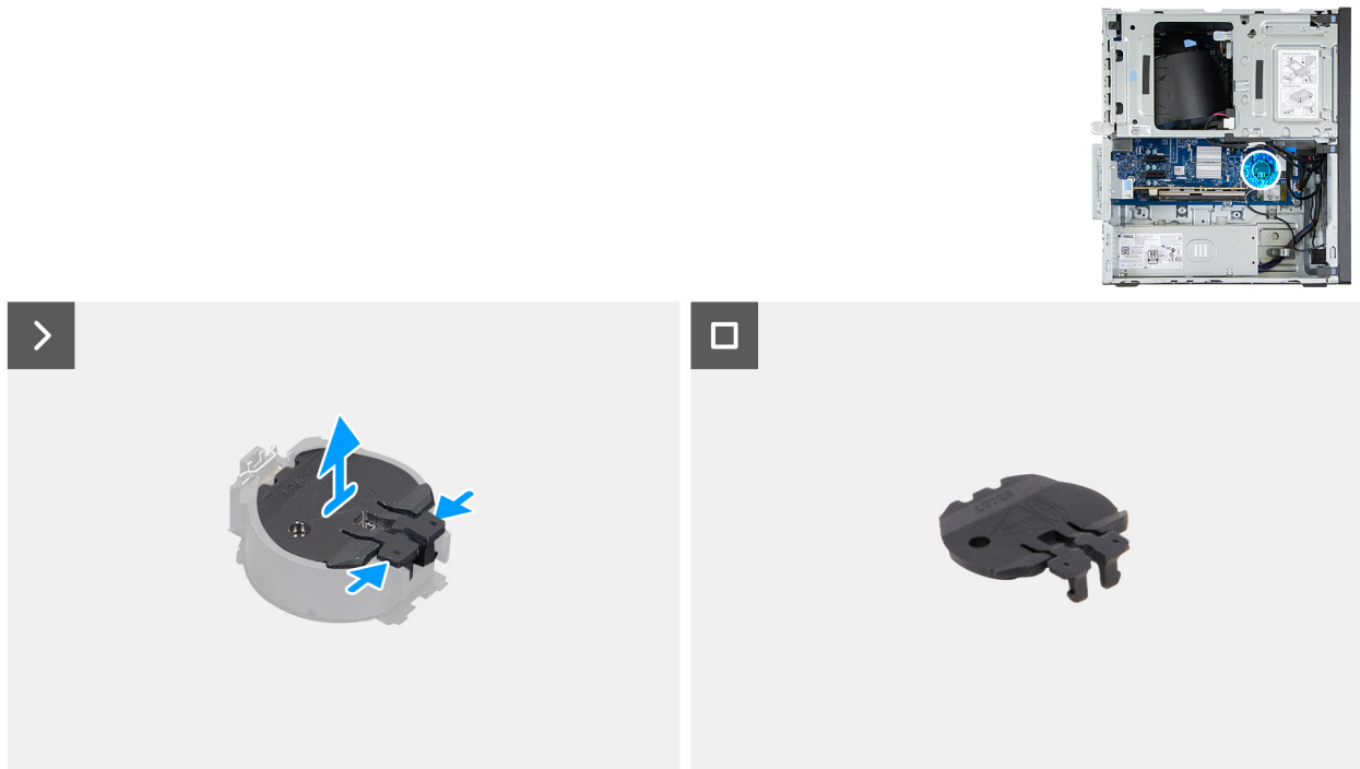
Figura 17. Rimozione del coperchio della batteria a bottone
