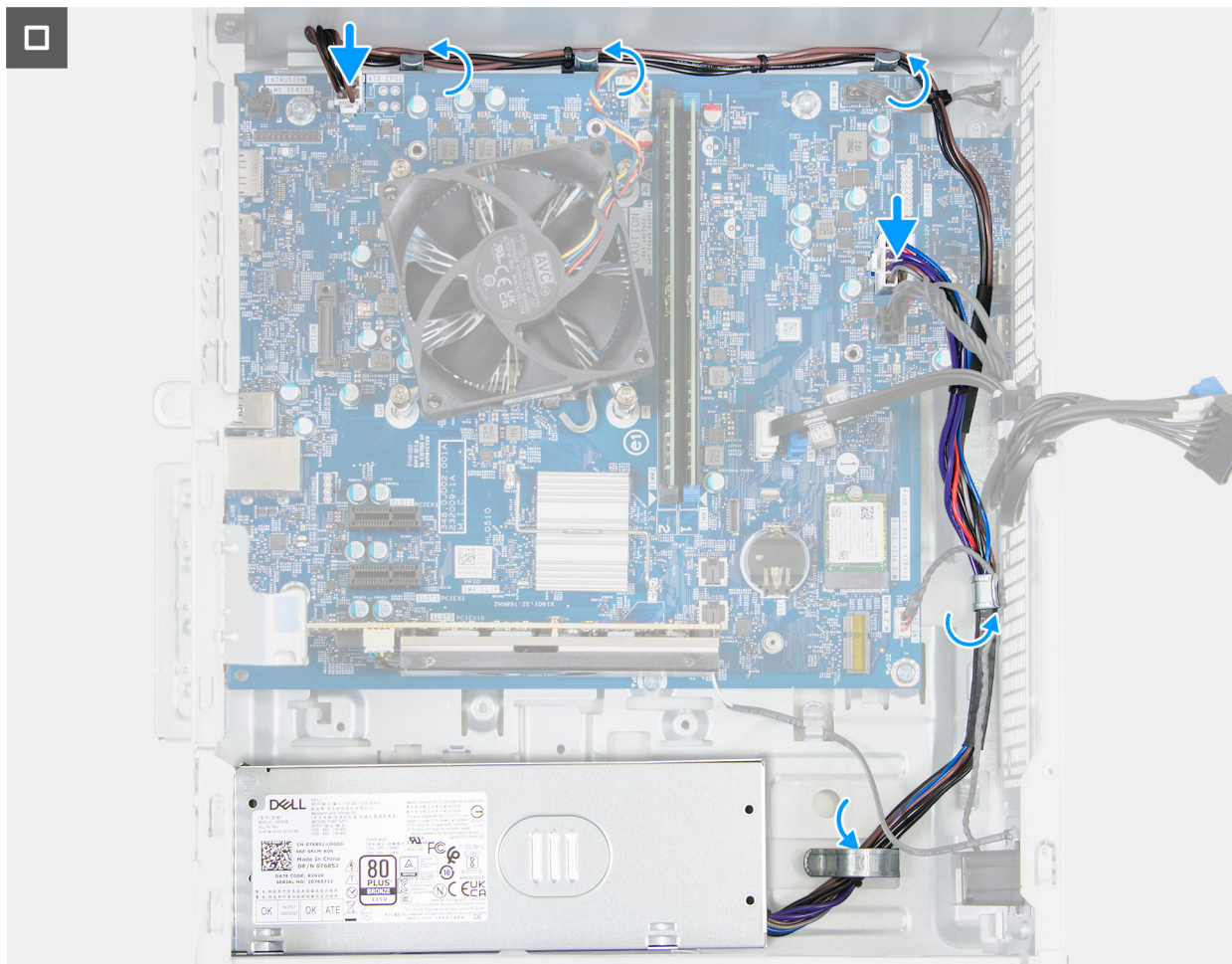
Figura 65. Installazione dell'unità di alimentazione
