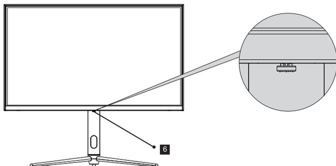
6. Indicatore: La spia blu fissa indica che l'alimentazione è accesa e il monitor funziona normalmente. La spia rossa indica che non è presente alcuna sorgente video, non è stato rilevato alcun segnale orizzontale o verticale o che la tensione è bassa. L'assenza di spia indica una condizione di spegnimento.
