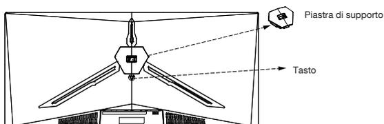
3. Rimuovere le viti originali x4 dall'apertura sul retro del monitor e metterle da parte. Quindi, utilizzare le viti fornite per fissare gli adattatori all'interno dell'apertura.
