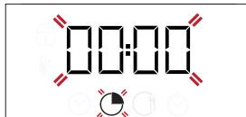
Za pomocą + lub - ustawić właściwy czas pieczenia i potwierdzić, wciskając . Włączyć funkcję, ustawiając pokrętło termostatu na żądaną temperaturę: sygnał dźwiękowy i wskazanie na wyświetlaczu oznaczają, że pieczenie zostało zakończone.
