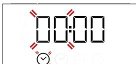
Pomocou + alebo — nastavte hodinu a stlačte ☺ na potvrdenie. Začnú blikať číslice označujúce minúty. Pomocou + alebo — nastavte minúty a stlačte ☺ na potvrdenie.
