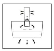
Les filtres à charbon actif sont utilisés pour absorber les odeurs.
