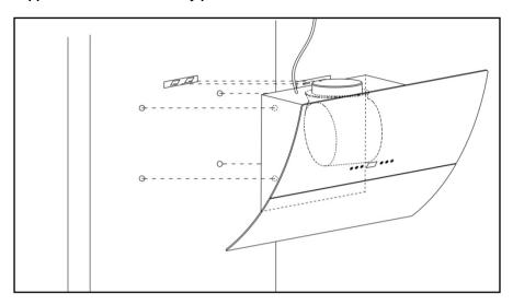
5. Fixer le clapet anti-retour pour la sortie d'air de la hotte. Puis, le tuyau d'échappement est à fixer sur le clapet anti retour comme indiqué ci-dessous
