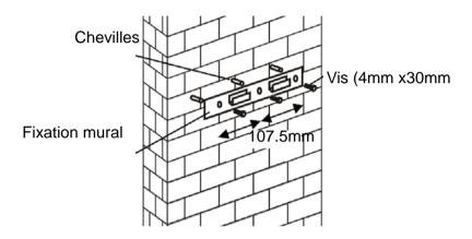
Pour le modèle en panneau incliné, avant l'installation, il faut percer 4 trous supplémentaires de 8mm et y placer les vis de fixation et vis de fermeture.
