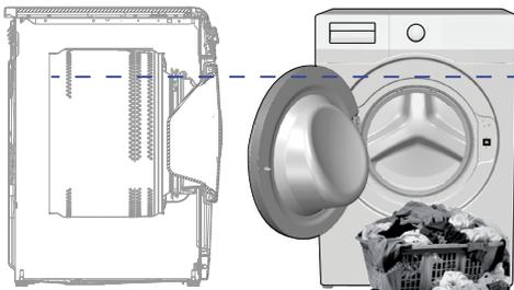
Nel programma Lavaggio da 5 kg e Asciugatura da 5 kg raccomandiamo di caricare la macchina fino al livello mostrato sopra per condizioni di asciugatura ideali (vedere la freccia del livello aprendo lo sportello di carico).
