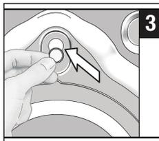
3 Inserire i coperchietti in plastica nei fori del pannello posteriore, in dotazione nel sacchetto allegato al manuale utente.
