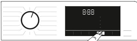
Quando si seleziona un nuovo programma di lavaggio, premere il pulsante di selezione della funzione ausiliaria per l'asciugatura per impostare l'opzione di asciugatura adatta a questo programma.
