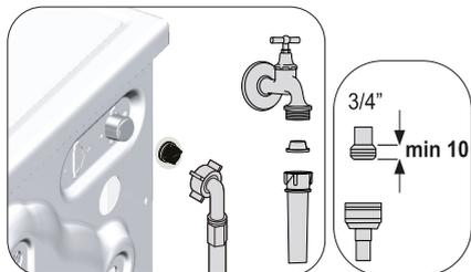
C'è un filtro nella parte terminale di ciascuna valvola di immissione dell'acqua sul lato posteriore della lavasciuga e anche alla fine di ciascun flessibile di immissione dell'acqua, nel punto di collegamento al rubinetto. Questi filtri evitano che le sostanze estranee e lo sporco dell'acqua entrino nella lavasciuga. I filtri devono essere puliti se sono sporchi.
