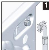
1 Collegare i flessibili specifici in dotazione con la lavasciuga alle valvole di ingresso dell'acqua sull'elettrodomestico.
