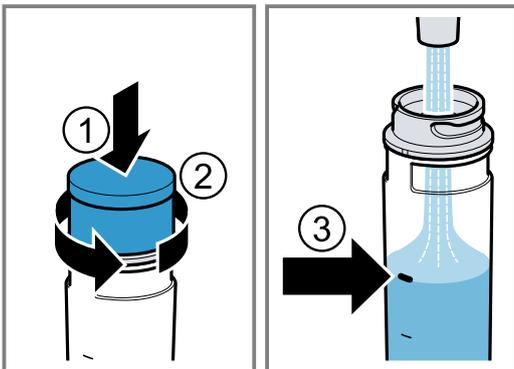
4. Premere sul coperchio del serbatoio dell'acqua ① e avvitare per chiuderlo ②.
