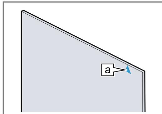
2. Inserire il pannello intermedio sotto il supporto [a] e ① premerlo in alto e fissarlo.
