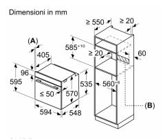
A: 19,5 mm B: Spazio per il collegamento dell'apparecchio 320 x 115 mm
