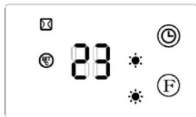
Si la température descend rapidement sous la valeur réglée, le programme éteint l'appareil et le met en veille : pour le réactiver, appuyer à nouveau sur la touche
