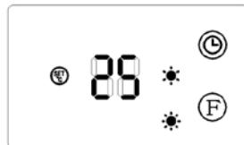
Se la temperatura ambiente è inferiore al valore impostato sul display, rimane in stand-by.
