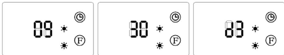
Remarque : si l'appareil est éteint (interrupteur latéral en pos.0), ou si la fiche est retirée de la prise, les réglages sont remis à zéro, et il est nécessaire de les régler à nouveau à la prochaine réinitialisation (heure/minute/jour).
