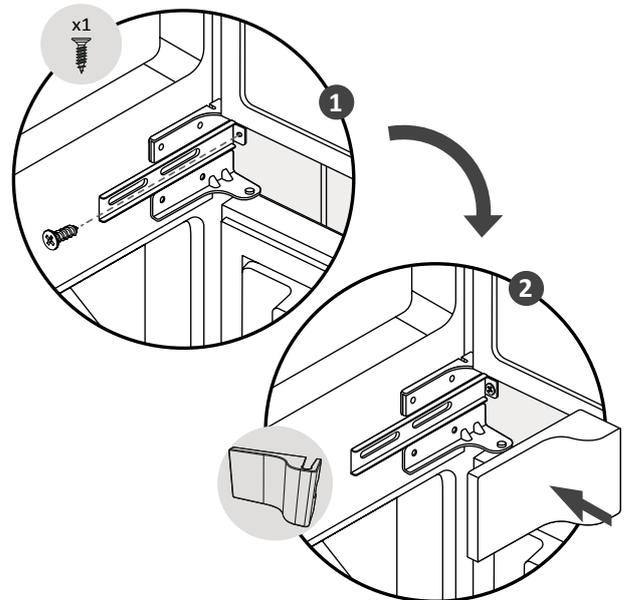
Una volta fissato il prodotto al mobile attraverso la staffa, posizionare il copricerniera.
