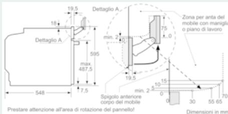
Se l'apparecchio viene montato sotto un piano di cottura deve essere rispettato il seguente spessore del piano di lavoro (event. incl. sottostruttura).
