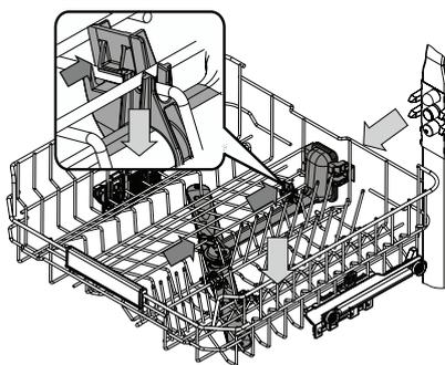
I residui di cibo possono occasionalmente formare incrostazioni sui bracci aspersori e bloccare i fori utilizzati per l'irrorazione dell'acqua. Si raccomanda pertanto di ispezionare di volta in volta i bracci e di pulirli mediante piccola spazzola metallica.
