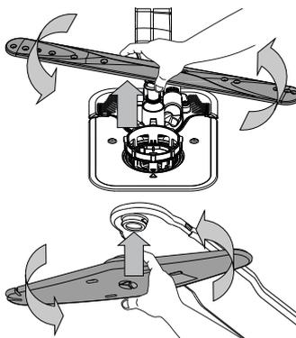
Il braccio di spruzzo inferiore può essere rimosso tirandolo verso l'alto e ruotandolo in senso antiorario. Il montaggio posteriore del braccio di spruzzo avviene tirandolo verso il basso e ruotandolo in senso orario.
