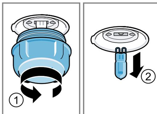
4. Inserire la lampadina alogena nuova e fissarla nell'attacco. Fare attenzione alla posizione del perno.
