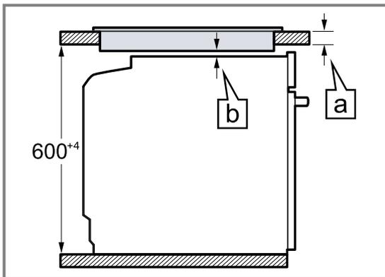
Sulla base della distanza minima necessaria **[b]** risulta lo spessore minimo del piano di lavoro **[a]**.
