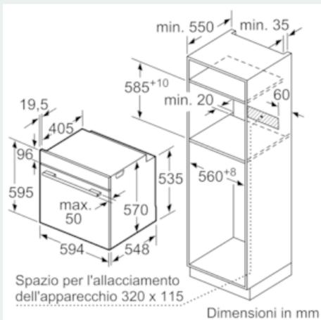
Montaggio con un piano di cottura.
