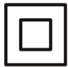
Ze względu na bezpieczeństwo użytkowników niniejsze urządzenie zostało wyposażone w podwójną izolację. **CE**
