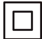
Este aparato, para su seguridad, ha sido diseñado con un doble aislamiento. **CE**
