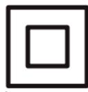
Este aparato, para su seguridad, ha sido diseñado con un doble aislamiento. **CE**
