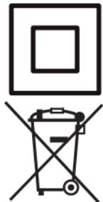
Ze względu na bezpieczeństwo użytkowników niniejsze urządzenie zostało wyposażone w podwójną izolację. **CE**
