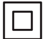
Este aparato, para su seguridad, ha sido diseñado con un doble aislamiento. **CE**
