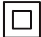
Dieses Gerät ist zu Ihrer Sicherheit mit einer doppelten Isolierung ausgestattet. **CE**
