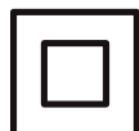
В целях обеспечения Вашей безопасности настоящий прибор оснащен двойной изоляцией. **CE**
