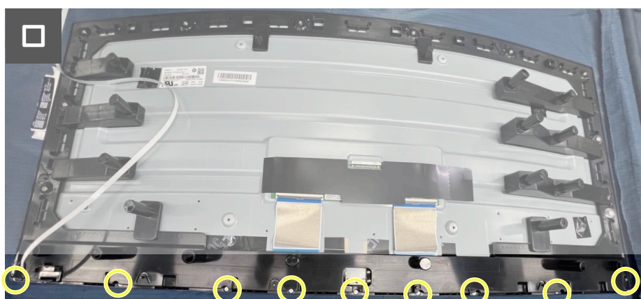
Figura 26. Rimozione della struttura centrale
