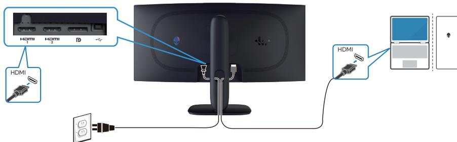
Figura 23. Collegamento del cavo HDMI
