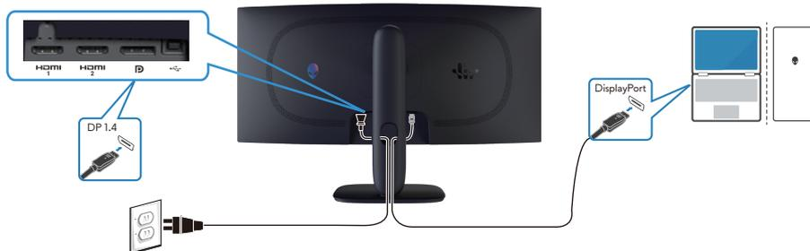
Figura 22. Collegamento del cavo DisplayPort (DP a DP)
