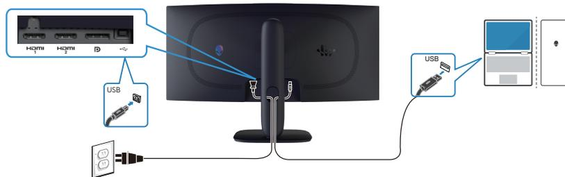
Figura 24. Collegamento del cavo USB tipo B (tipo B-tipo A)
