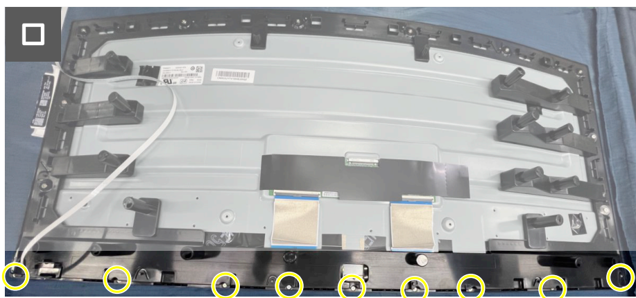
Figura 36. Rimozione della struttura centrale
