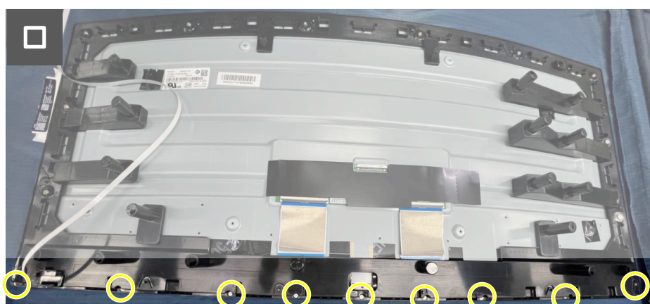
Figura 37. Installazione della struttura centrale
