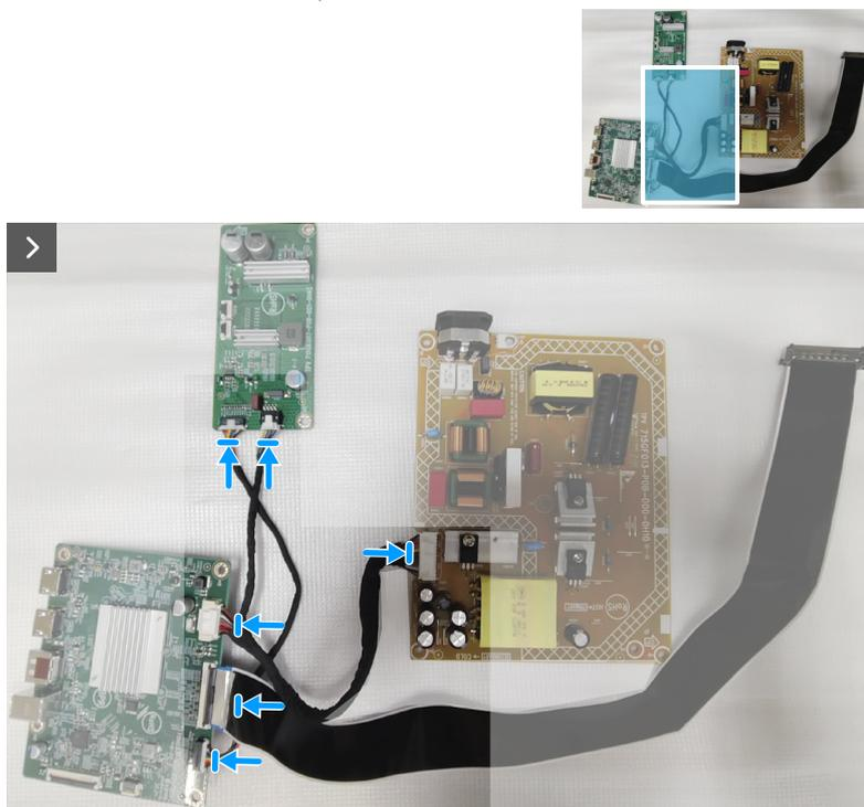
**Figura 23. Installazione della scheda di sistema e della scheda di alimentazione**
