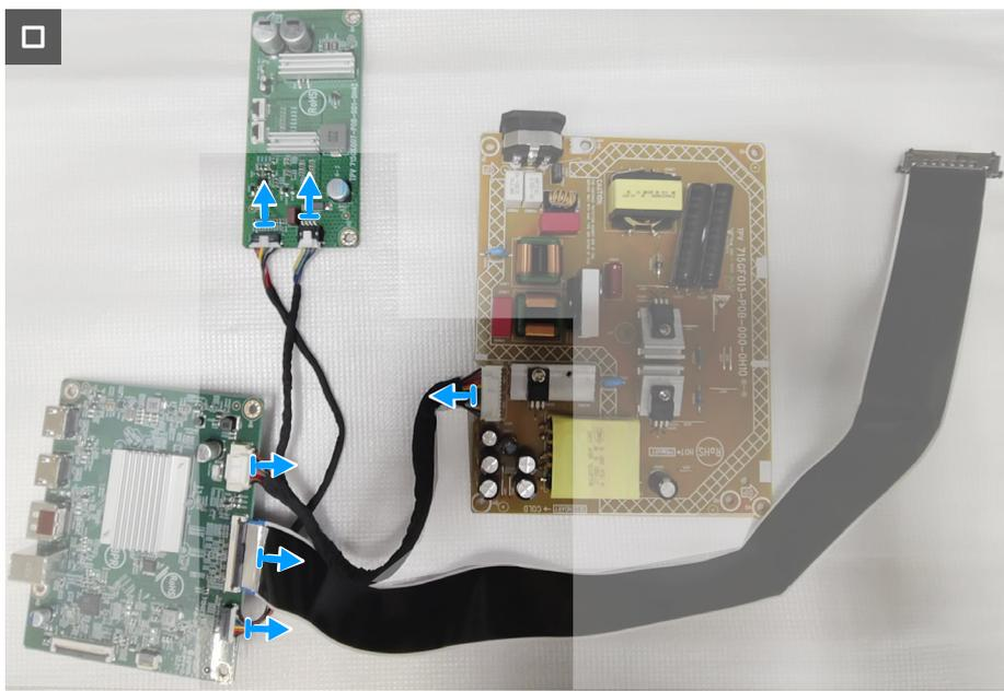
**Figura 22. Rimozione della scheda di sistema e della scheda di alimentazione**
