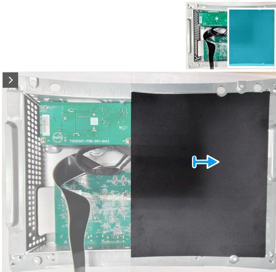
**Figura 20. Rimozione della scheda di sistema e della scheda di alimentazione**
