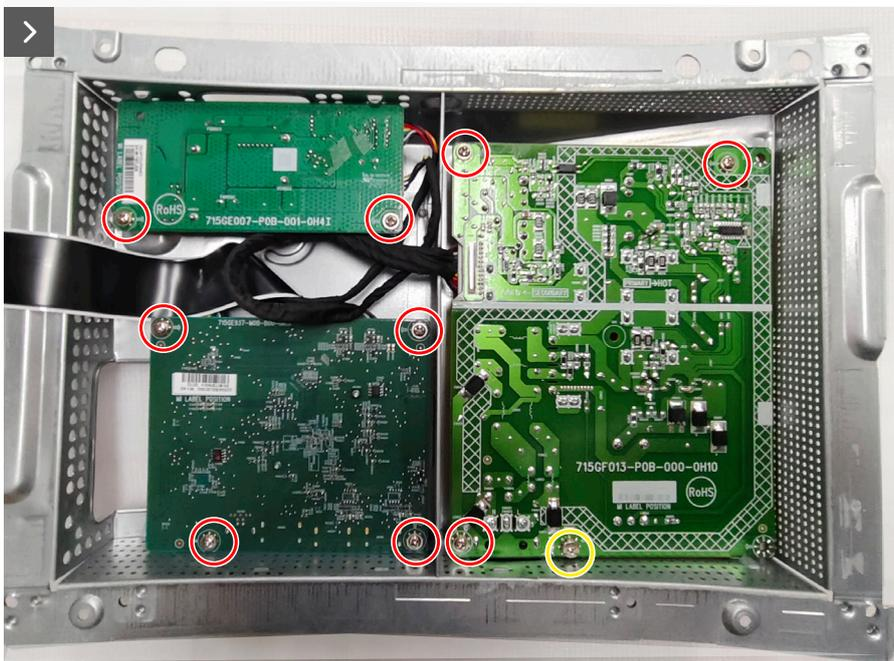
**Figura 21. Rimozione della scheda di sistema e della scheda di alimentazione**
