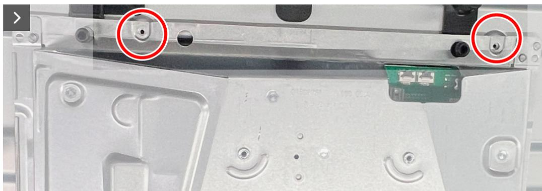
**Figura 16. Installazione della schermatura metallica**
