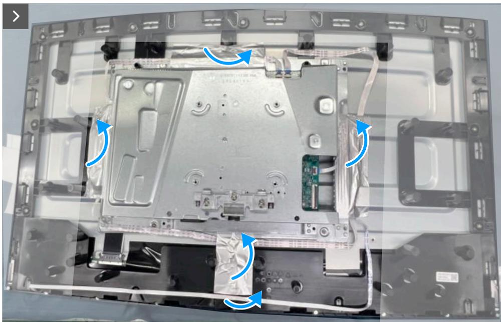
**Figura 10. Rimozione della schermatura metallica**
