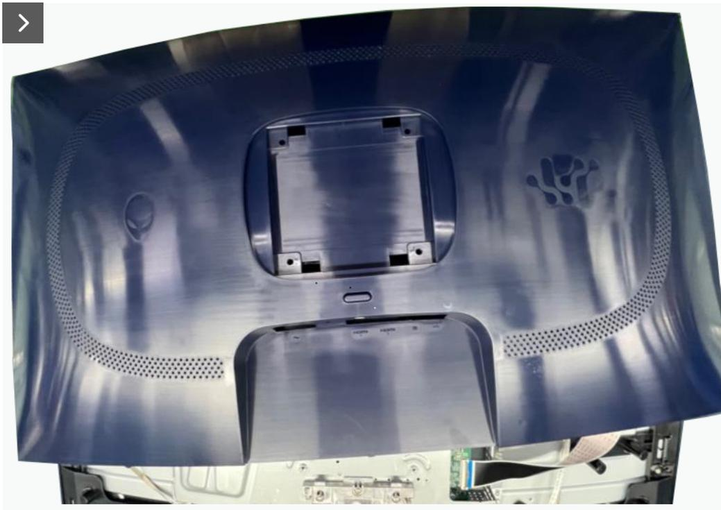
**Figura 5. Rimozione del coperchio posteriore**
