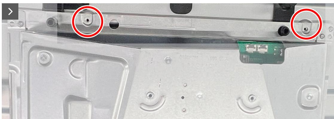
**Figura 12. Rimozione della schermatura metallica**
