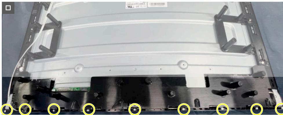
**Figura 26. Rimozione della struttura centrale**
