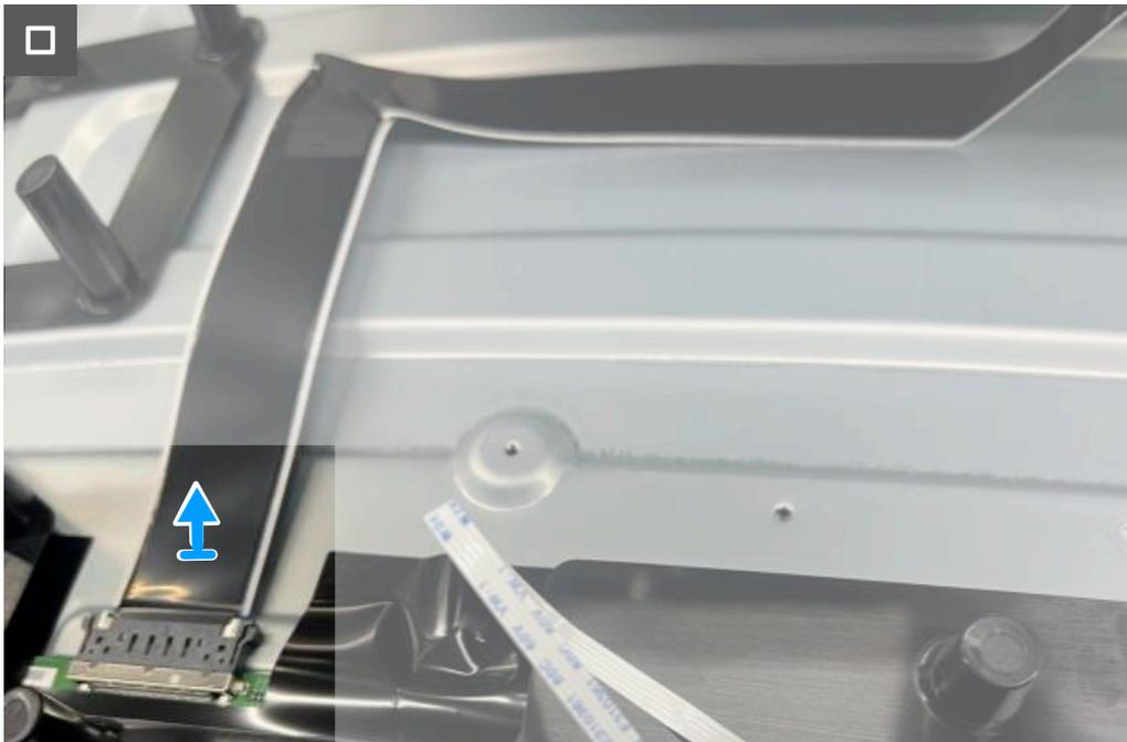
**Figura 14. Rimozione della schermatura metallica**
