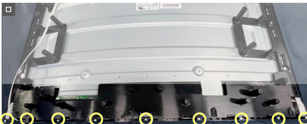
**Figura 27. Installazione della struttura centrale**
