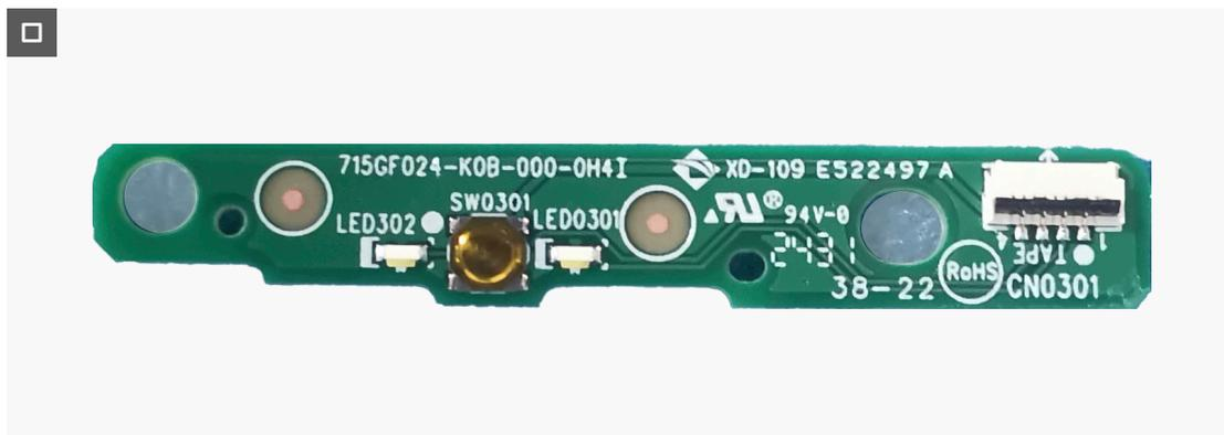
**Figura 29. Rimozione della scheda del tasto di alimentazione**
