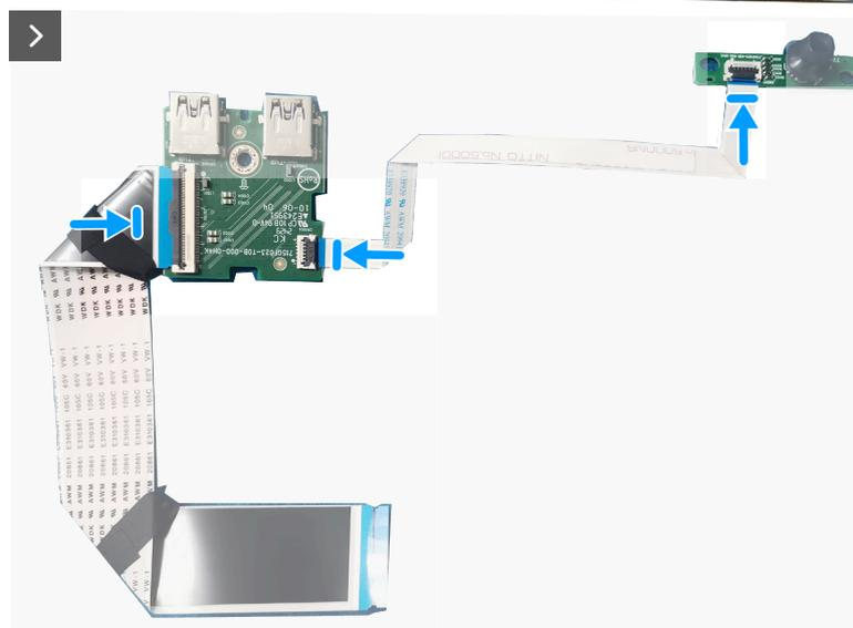
**Figura 33. Installazione della scheda I/O e della scheda del tasto del joystick**
