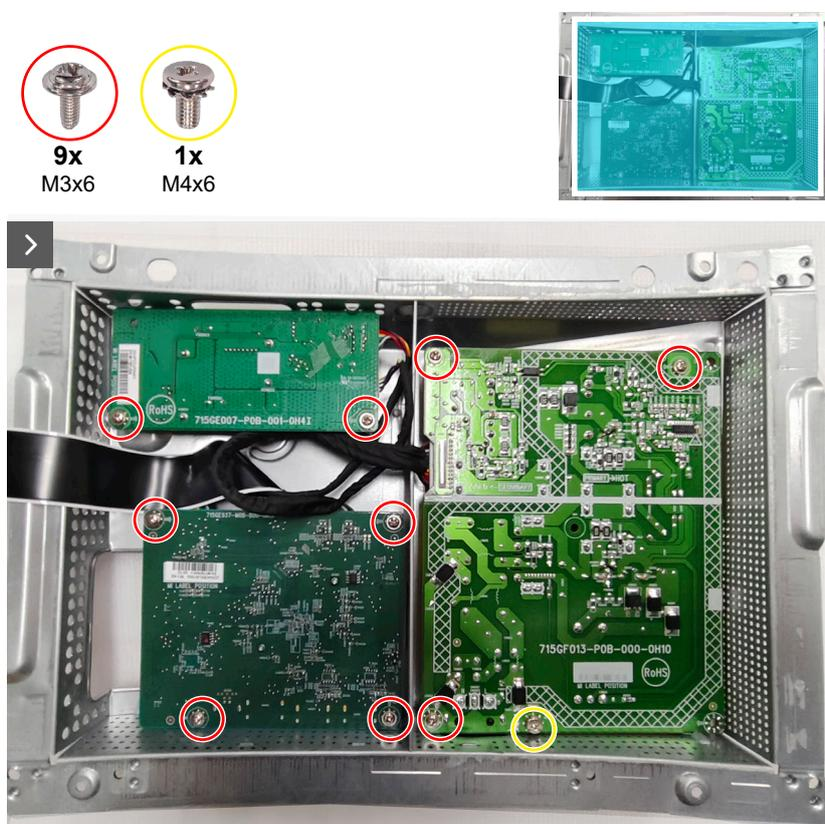
**Figura 24. Installazione della scheda di sistema e della scheda di alimentazione**
