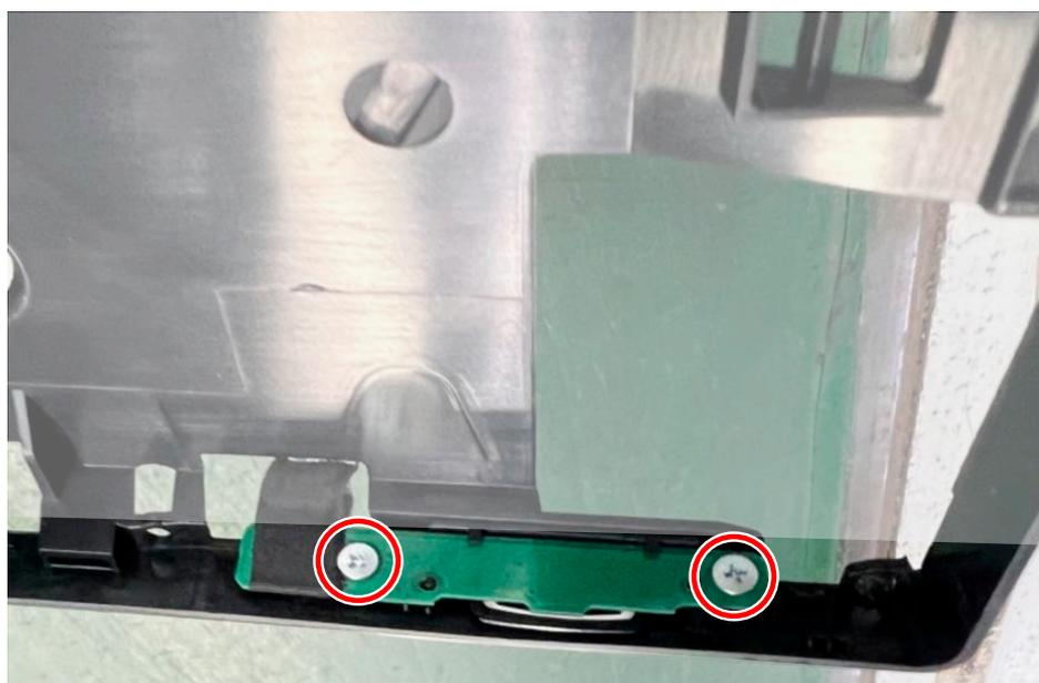
**Figura 30. Installazione della scheda del tasto di alimentazione**
