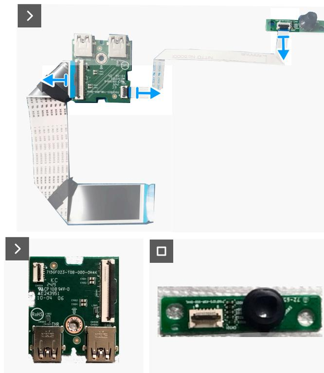
**Figura 32. Rimozione della scheda I/O e della scheda del tasto del joystick**
