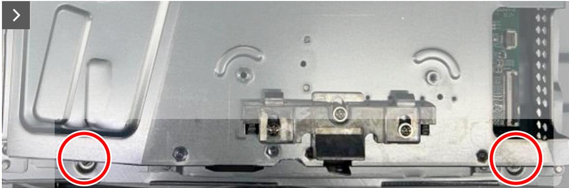
**Figura 17. Installazione della schermatura metallica**
