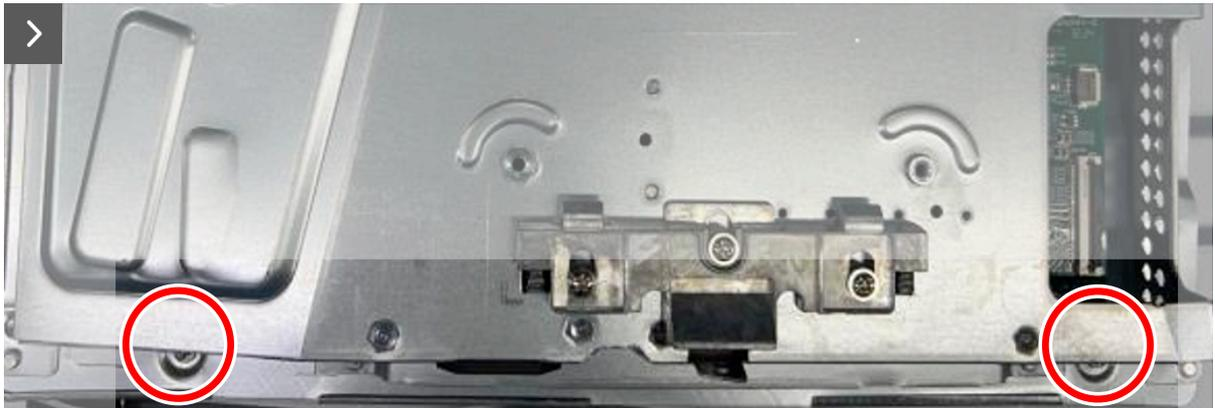
**Figura 13. Rimozione della schermatura metallica**
