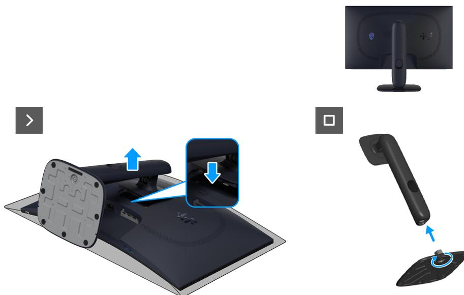
Figura 1. Rimozione del supporto
