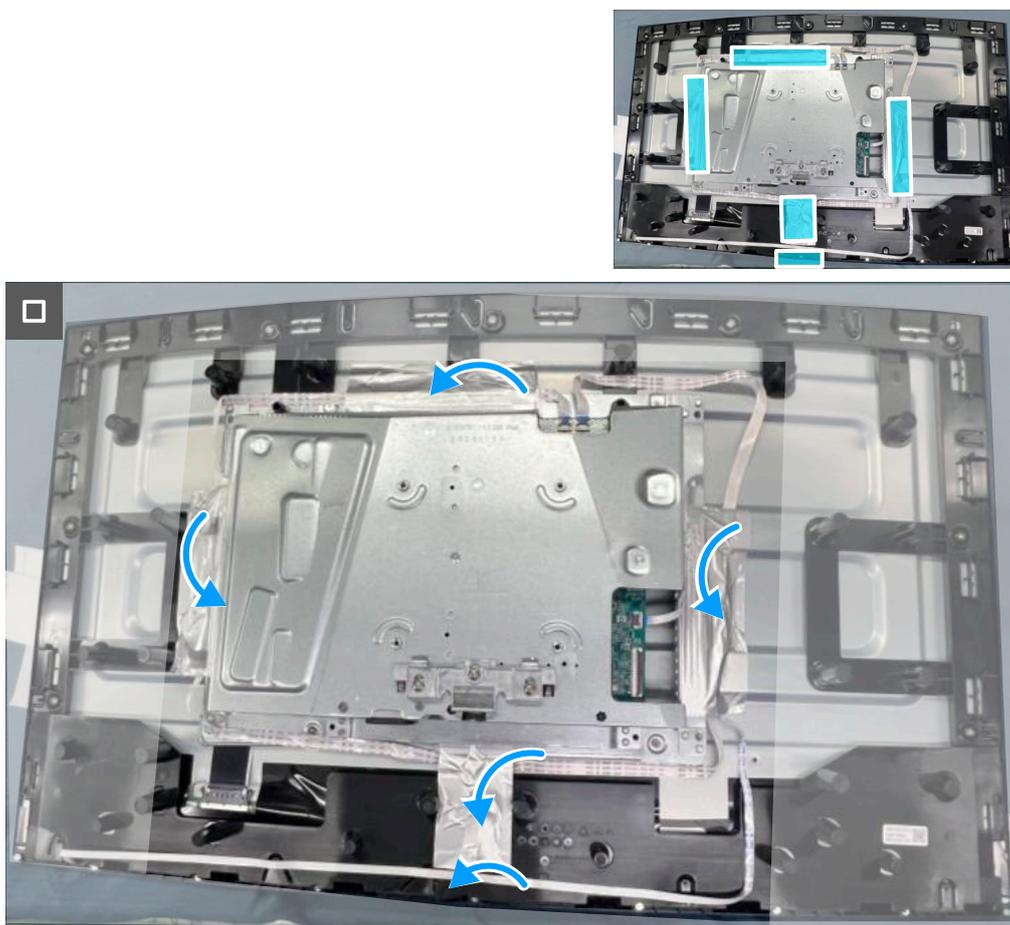
**Figura 19. Installazione della schermatura metallica**
