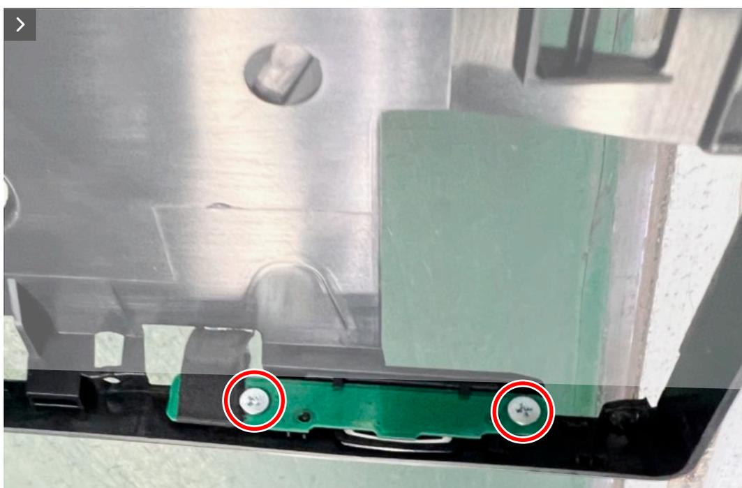
**Figura 28. Rimozione della scheda del tasto di alimentazione**
