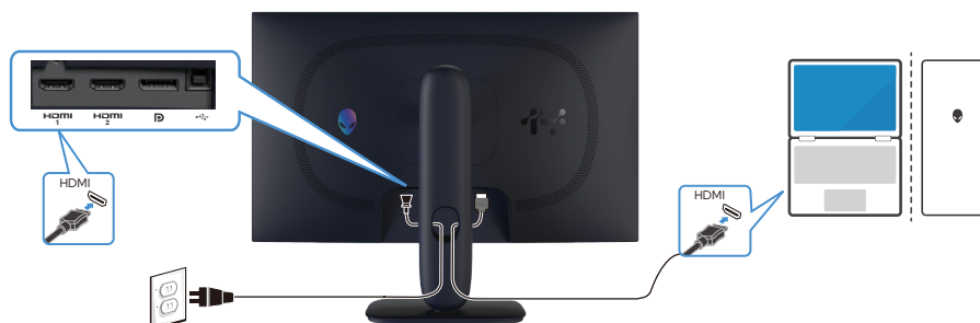
Figure 29. Collegamento del cavo HDMI
