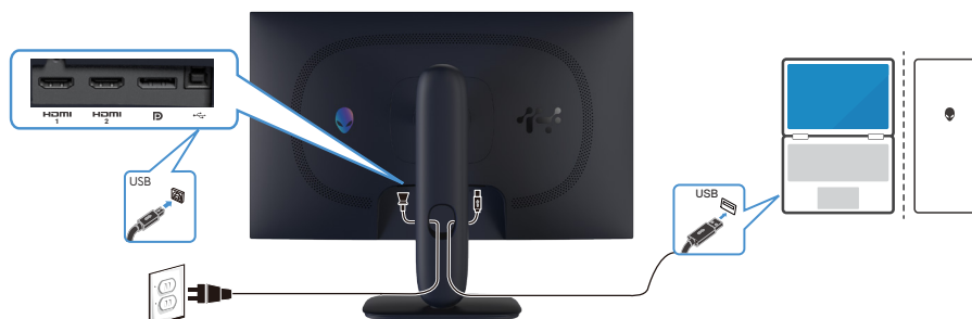
Figure 30. Collegamento del cavo USB tipo B (tipo B-tipo A)
