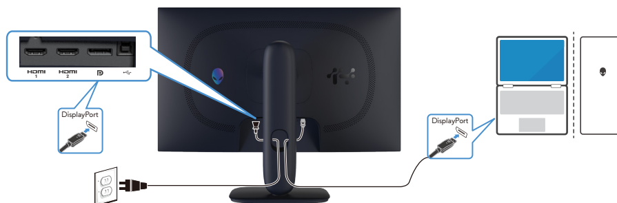
Figure 28. Collegamento del cavo DisplayPort (DP a DP)
