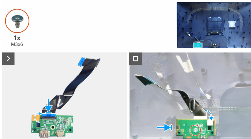
Figura 16. Installazione della scheda USB
