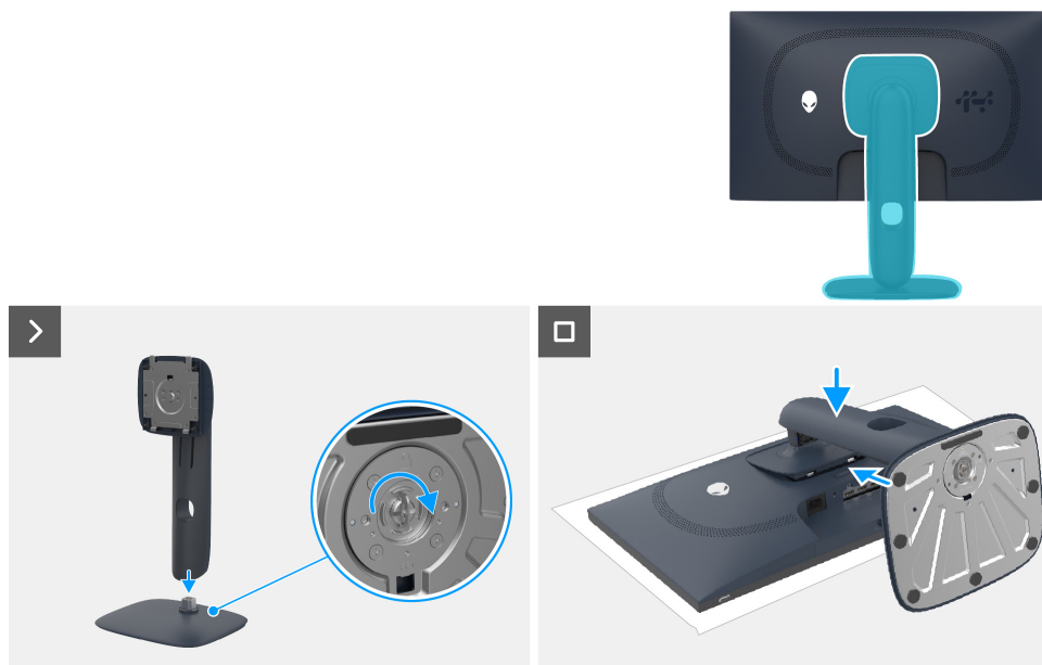
Figura 10. Installazione del supporto
