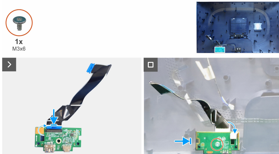
Figura 8. Installazione della scheda USB
