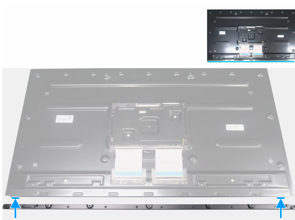
Figura 18. Installazione della mascherina anteriore.
