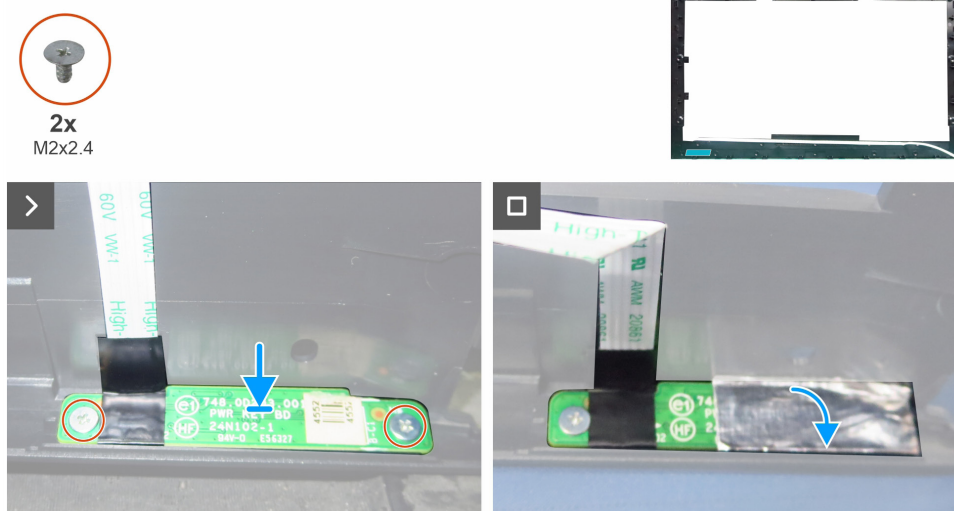
Figura 16. Installazione della scheda del tastierino
