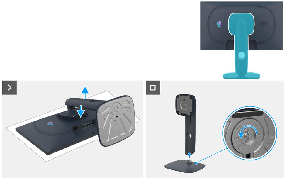
**Figura 9. Rimozione del supporto**
