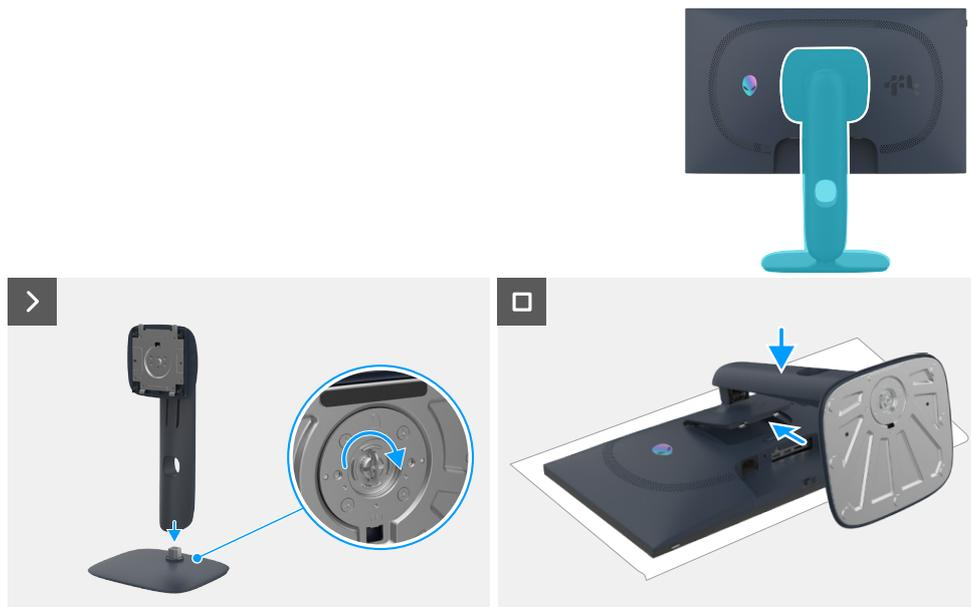
**Figura 10. Installazione del supporto**
