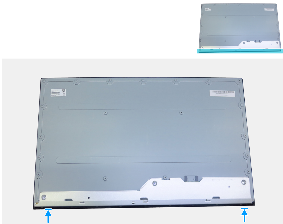
Figura 14. Installazione della cornice anteriore
