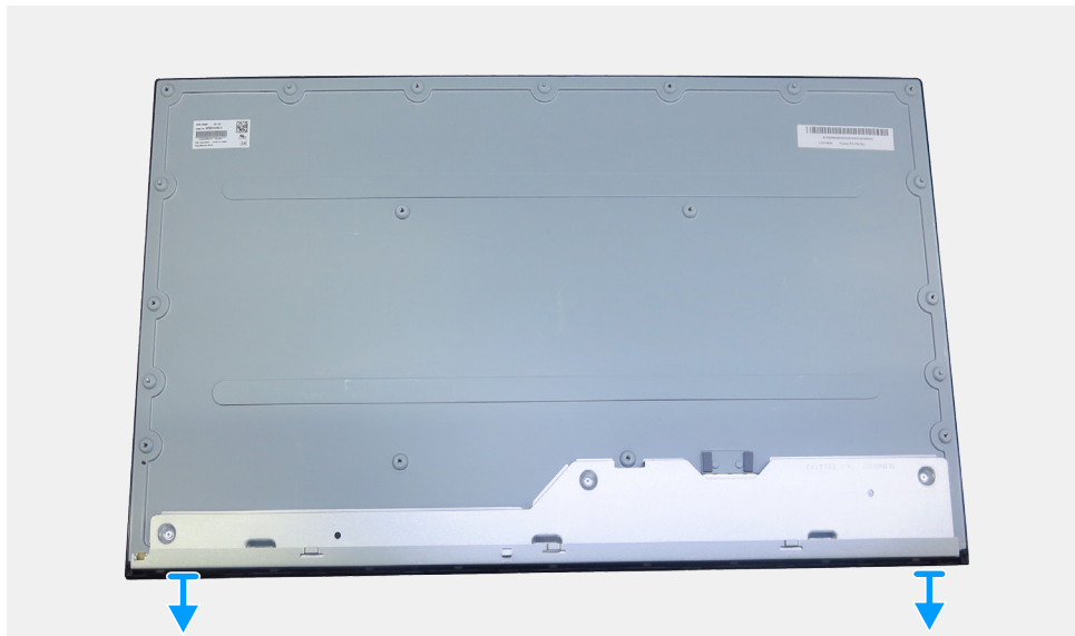
Figura 13. Rimozione della cornice anteriore
