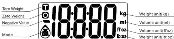
T, indicatore operazione TARA                      0, indicatore operazione ZERO                      -, valore negativo
