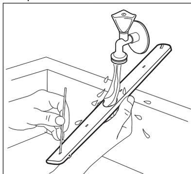
4. Per re-installare il mulinello (C), inserire l'elemento di montaggio (B) nel mulinello e fissarlo nel tubo di erogazione (A) ruotandolo in senso orario. Assicurarsi che l'elemento di montaggio si blocchi in posizione.
