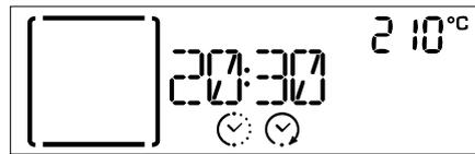
Note: programmare l'avvio ritardato di una cottura, disattiva in ogni caso la fase di preriscaldamento del forno: la temperatura desiderata viene raggiunta gradualmente, quindi i tempi di cottura si allungheranno leggermente rispetto a quanto indicato nella tabella di cottura.
