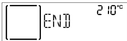
Premere **OK select** per continuare la cottura in modalità manuale (senza una durata impostata) o ruotare la *manopola di regolazione* per prolungare la cottura impostando una nuova durata. In entrambi i casi, i valori della temperatura o del livello del grill saranno mantenuti in memoria.
