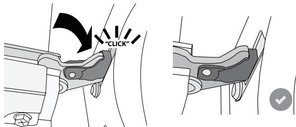
**5.** Prøv å lukke døren og sjekk for å være sikker på at den er på linje med kontrollpanelet. Hvis den ikke gjør det, gjenta trinnene ovenfor: Døren kan bli skadet hvis det ikke fungerer som den skal.
