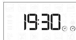
Anmärk: När en födröjd start programmeras avaktiveras ugnens förvärmningsfas. Ugnen kommer att uppnå önskad temperatur gradvis, vilket betyder att tillagningstiderna är något längre än de som listas i tillagningstabellen.
