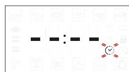
Cuando parpadee el ícono
