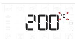
Cuando el ícono  $^{\circ}\text{C}/^{\circ}\text{F}$  parpadee en la pantalla, gire el selector para cambiar el valor y después pulse
