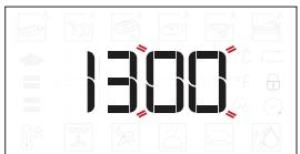
Op het display gaan de twee cijfers die de minuten aangeven knipperen. Draai aan de knop om de minuten in te stellen en druk op **OK** om te bevestigen.
