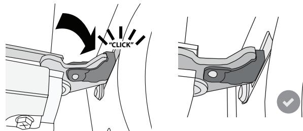
**5.** Prøv at lukke lågen, og tjek for at sikre, at den flugter betjeningspanelet. Hvis det ikke er tilfældet, skal du gentage ovenstående trin: Lågen kan blive beskadiget, hvis den ikke fungerer rigtigt.
