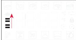
Sobald diese Phase beendet ist, ertönt ein akustisches Signal und das Display zeigt an, dass der Backofen die eingestellte Temperatur erreicht hat.
