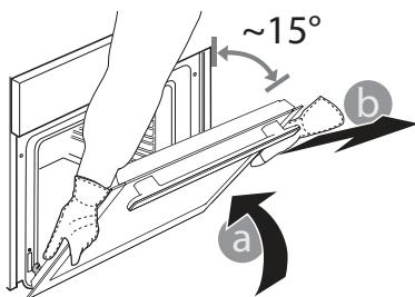
**3.** Montera tillbaka luckan genom att flytta den mot ugnen, rikta in gångjärnens krokar i höjd med dess fästen och säkra den övre delen i fästet.
