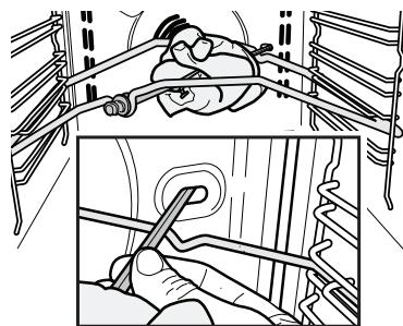
Sätt in dess ände i öppningen i ugnsutrymmet och låt den rundade delen vila på motsvarande stöd.
