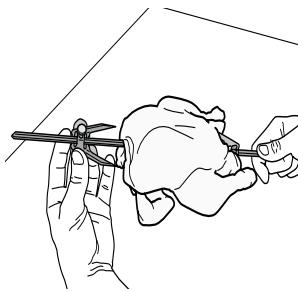
Poussez la broche à travers le centre de la viande (attachez la volaille avec de la ficelle) et glissez la viande jusqu'à la fourchette ; la viande ne doit plus pouvoir bouger. Poussez la deuxième fourchette sur la broche pour qu'elle maintienne la viande fermement en place. Serrez la vis de fixation.
