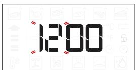
Op het display gaan de twee cijfers die het uur aangeven knipperen: Draai aan de knop om het uur in te stellen en druk op **OK** om te bevestigen.
