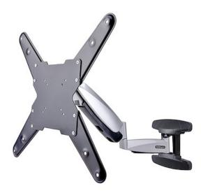
La struttura in acciaio e alluminio di questo supporto a parete per TV VESA supporta televisori da 23" a 55" e fino a 30 kg di peso. Il braccio consente di regolare l'altezza con un solo tocco grazie al meccanismo a molla che funge da contrappeso. La piastra VESA supporta schemi di montaggio da 75x75 a 400x400.
