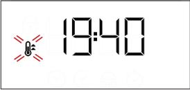
Lütfen dikkat edin: Pişirme sırasında, seçim düğmesini çevirerek işlevi değiştirebilir veya termostat düğmesini çevirerek sıcaklığı ayarlayabilirsiniz. Termostat düğmesi 0 °C'nin üstünde değilse işlev başlatılmayacaktır. Pişirme süresini, pişirme bitiş saatini (yalnızca bir pişirme süresi ayarlamışsanız) ve bağımsız zamanlayıcıyı ayarlayabilirsiniz.
