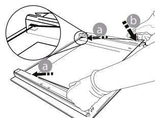
**4.** Replacez le bord supérieur : un déclic indique le positionnement correct. Assurez-vous que le joint est bien placé avant de replacer la porte.
