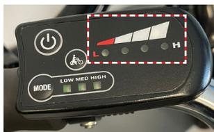
In condizioni normali, accendere l'alimentazione elettrica e, successivamente, le quattro luci a LED si accenderanno nel caso in cui la batteria sia completamente carica. Se rimane acceso solo un LED su quattro, la carica si sta esaurendo e la batteria deve essere ricaricata immediatamente.
