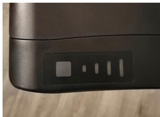
Ricordare di caricare la batteria completamente prima di avviarsi per un lungo viaggio! Premere il pulsante all'estremità del vano batteria, quando i 3 led di colore verde sono accesi la batteria è completamente carica (Fig. 5.1.)
