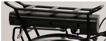
La e-bike ha la batteria posizionata all'interno del portapacchi (la batteria è direttamente collegata all'unità di controllo nella parte anteriore (fig. 2).
