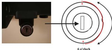
Dalla posizione iniziale (ore 12), premere la chiave e ruotare in senso orario in posizione ore 6 per effettuare il bloccaggio. Effettuare il procedimento inverso per lo sbloccaggio.
