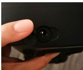
Se una presa di corrente è vicina alla batteria, è possibile caricare la bici direttamente con la batteria montata, senza l'obbligo di doverla sfilare dal proprio alloggiamento. La porta di ricarica è coperta da un cappuccio di plastica (Fig. 4.3), è sufficiente aprire la copertura di sicurezza per mettere direttamente in carica la batteria.
