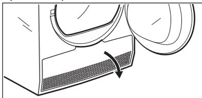
3. Ruotare le leve per sbloccare il coperchio del condensatore e abbassare il coperchio del condensatore.
