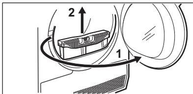
2. Aprire la copertura del condensatore.
