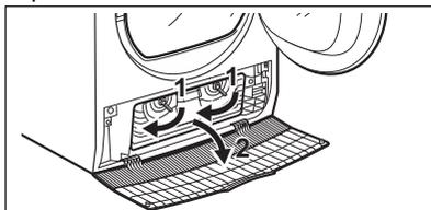
4. Se necessario, togliere la lanugine dal condensatore e dal suo alloggiamento. È possibile utilizzare un aspirapolvere con un accessorio a spazzola.
