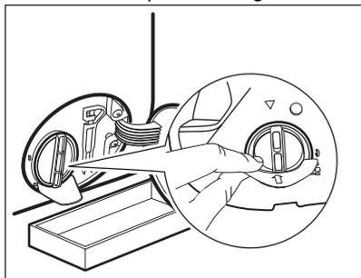
4. Ruotare il filtro di 180 gradi in senso anti-orario per aprirlo, senza rimuoverlo. Lasciare che l'acqua fuoriesca.
