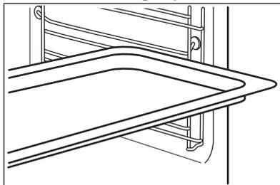
Spingere la lamiera tra le guide del supporto ripiano. Posizionare la lamiera dolci con la pendenza verso la parte posteriore dell'interno del forno.
