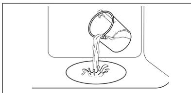
La capacità massima dell'incavo della cavità è 250 ml. Non riempire la goffatura della cavità con acqua durante la cottura o quando l'apparecchiatura è calda.
